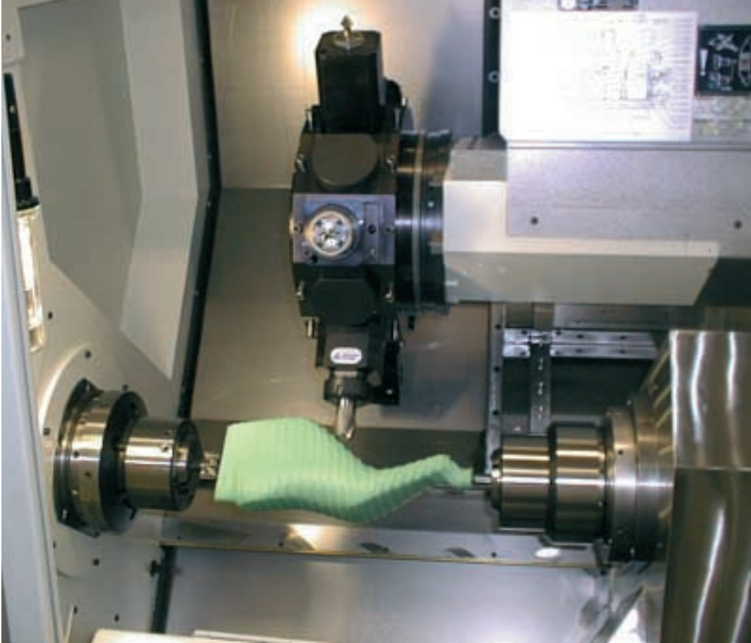
Der zwischen Spitzen gespannte Leistenrohling wird nach dem Schrappen auf Fertigmaß geschlichtet.
