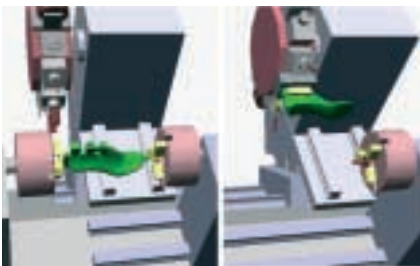
Die Leistenbearbeitung erfolgt in zwei Phasen. Links: Spannen zwischen Spitzen. Rechts: Spannen am Kamm.
