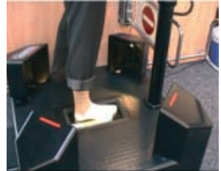
Der optische Fußscanner fotografiert den Fuß aus fünf Richtungen, vier Seitenansichten und einer Untersicht.
