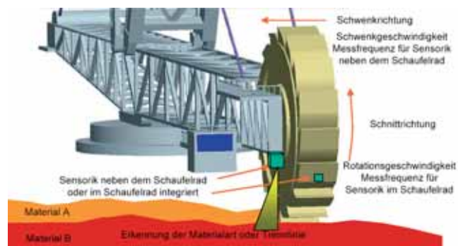
Bild 1: Platzierung der Sensoriken am Schaufelradbagger.
