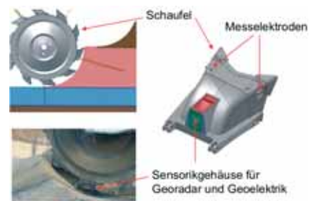
Quelle: ITA Bild 4: Integration der Sensorik in das Schaufelrad.
