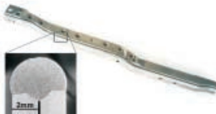
Beim Cockpit-Querträger des Golf V werden zwei Halbschalen mit Bördelnähten mittels NVEBW verschweißt. Im Querschliff durch die Schweißnaht ist die geforderte gute Rundung zu erkennen.
