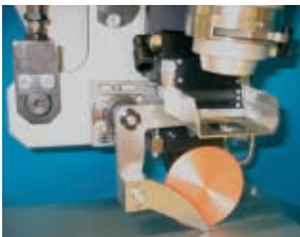
Ein Messfinger misst den Spalt, der mittels einer mitlaufenden Andruckrolle auf die richtige Größe eingeregelt wird.
