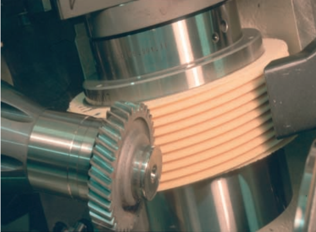
Kontinuierliches Wälzschleifen mit abrichtbarer Wälzschnecke.
