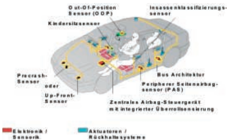
Abb. 4: Der Einsatz von Sensoren im Airbag-Sicherheitsystem ist sehr vielseitig. 6)
