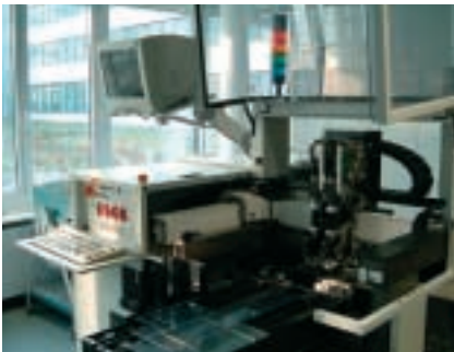
Hochpräziser Bestückungsautomat zur Verarbeitung von SMD-Bauteile, \mu BGAs, Chips und speziellen Bauteilformen.
