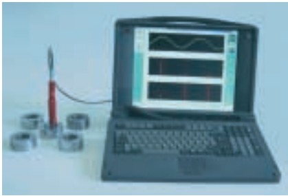
Mit dem am IW-ZfP realisierten Mess- und Analysesystem lassen sich auch Werkstoffe sortieren.
