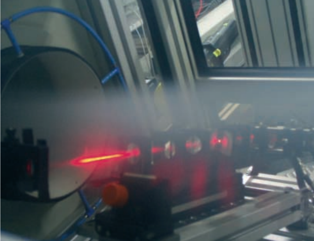
Zur Vermessung der Grenzschicht einer umströmten Platte befindet sich der Geschwindigkeitsprofilsensor in die Experimentierkammer eines Windkanals.
