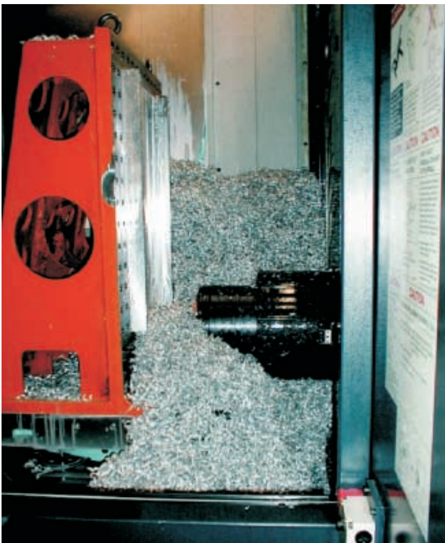
Bei Fräsprozessen im Hochleistungs-Bereich ist der Abtransport der Späne eine besondere Aufgabe.
