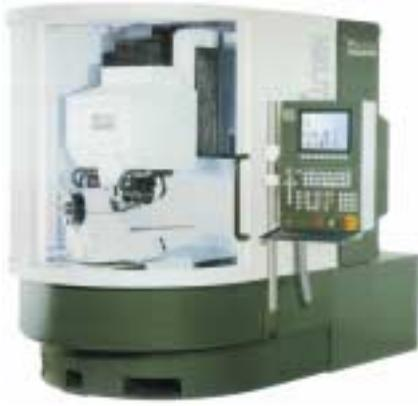
**Mit der 5-Achs-Schleifbearbeitung lassen sich beliebige Werkzeuggeometrien schleifen.**
