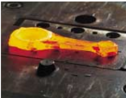
Durch neuartige Produktionstechnologien wie dem endkonturnahen Schmieden im geschlossenen Gesenk lassen sich Hochleistungsbauteile effizienter produzieren.
